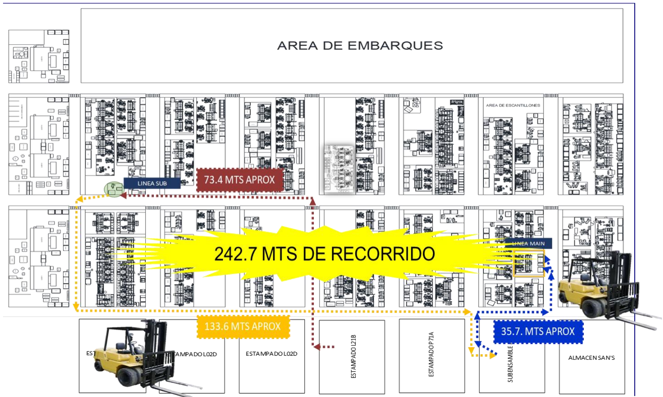
Figura 19 Situación actual, recorrido de montacargas de línea de sub-ensamble a línea principal. Fuente: Unipres Mexicana, 2022
