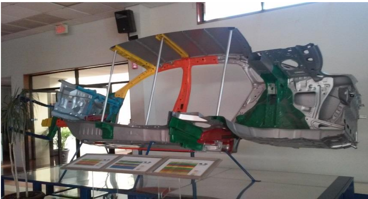
Figura 9 Clasificación por color, carrocería principal fabricada en Unipres Mexicana. Fuente: Unipres Mexicana, 2022
